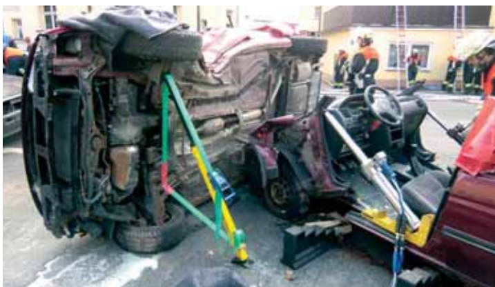
Abstützen mittels Weber Stab-Fast System
