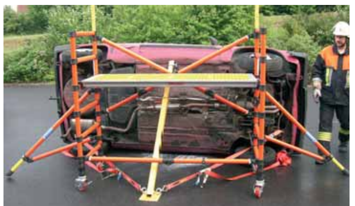
Abstützen mittels selbstgebauter Stütze und Ratschengurten
