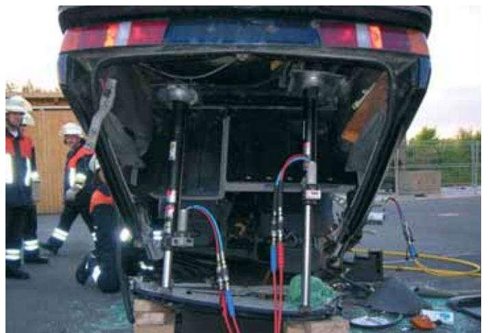
Abstützen mittels Rettungszylindern
