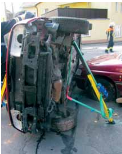
Abstützen mittels Weber Stab-Fast System
